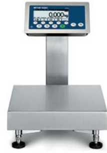
S 型 终端通过立柱安装在PBD659和 PBA639秤台任意一边，仅安装在 PBA436和PBA439秤台短边。 方便走线及清理。
