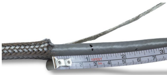
Figura 2-32: Marcação da camisa do cabo
