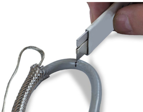
Figura 2-33: Corte alrededor del forro del cable
