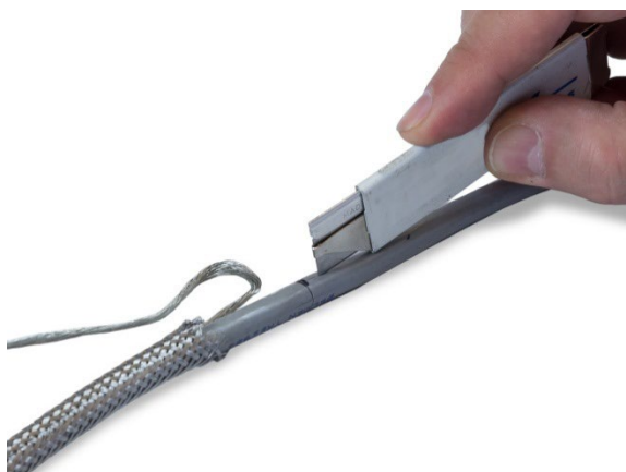
Figura 2-34: Cortando ao longo da camisa de cabo
