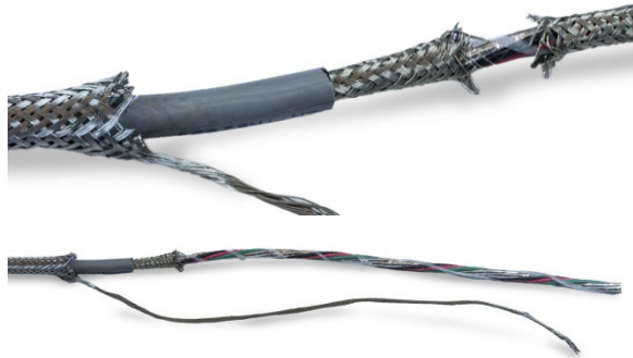
Figura 2-37: Retiro de la protección trenzada interna
