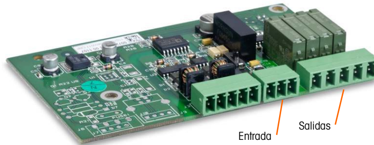
Figura 2-65: Tarjeta opcional COM2 con E/S discretas
