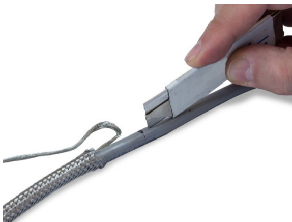
Figure 2-34 : Découpe de la gaine du câble
