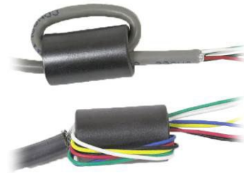
Figura 2-15: Instalação do núcleo de ferrite
