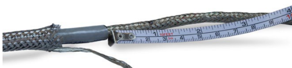
Figura 2-36: segno sulla schermatura intrecciata interna
