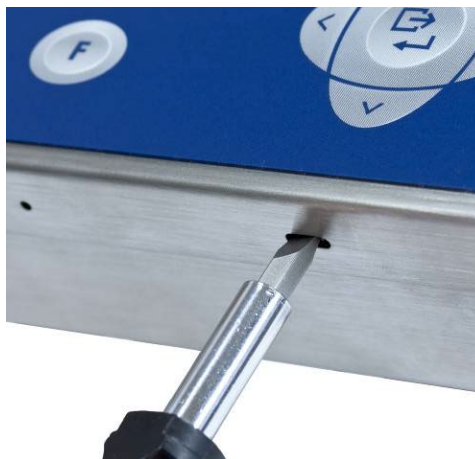
Figure 2-1 : Ouverture de l'enceinte pour environnement difficile
