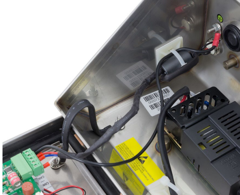
Figura 2-56: Conector de PowerDeck instalado en el IND246 POWERCELL
