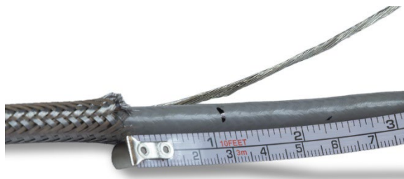
Figura 2-32: Marcación del forro del cable
