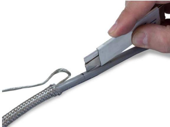
Figura 2-34: taglio longitudinale della guaina del cavo
