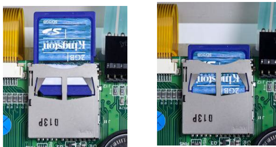
Figura 2-73: Deslizar um cartão SD no soquete SD (esquerda); cartão SD instalado (direita)
