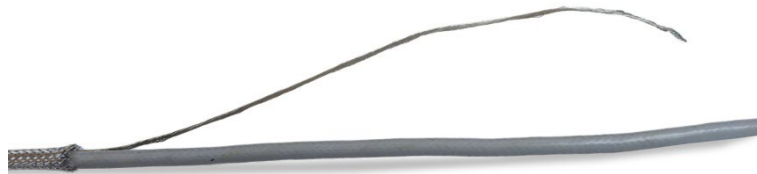
Figura 2-31: schermatura intrecciata esterna accorciata
