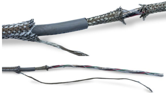
Figura 2-37: Removendo a blindagem trançada interna
