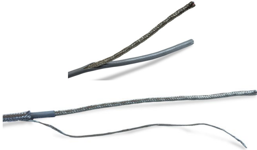
Abbildung 2-34: Kabelummantelung vom inneren Schirmgeflecht abziehen
