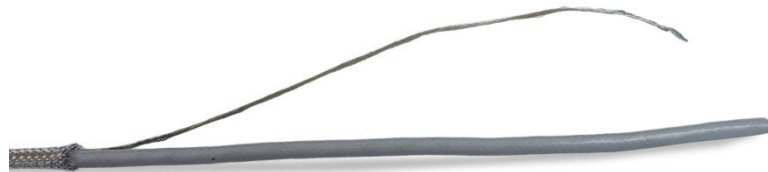
Figure 2-31 : Blindage tressé externe replié
