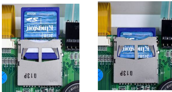
Figura 2-73: Inserimento di una scheda SD nella presa SD (sinistra); scheda SD installata (destra)
