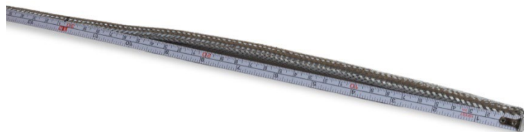
Figure 2-29 : Mesure du blindage tressé extérieur avant la coupe
