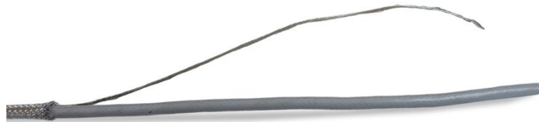
Abbildung 2-30: Zurückgeschnittenes äußeres Schirmgeflecht
