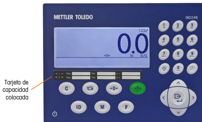
Figura 2-76: Tarjeta de capacidad colocada
