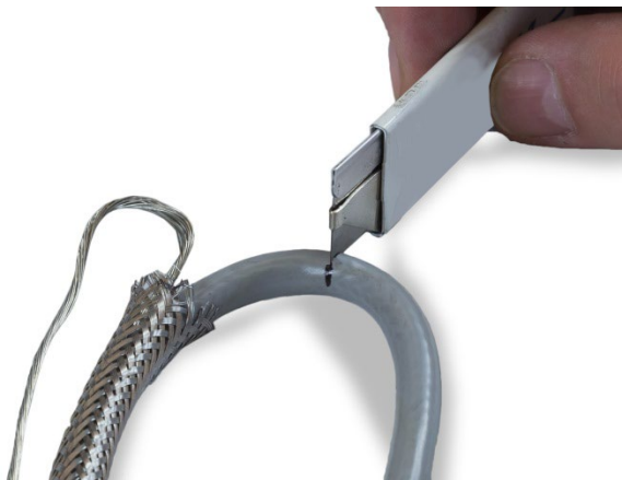
Figure 2-33 : Découpe autour de la gaine du câble
