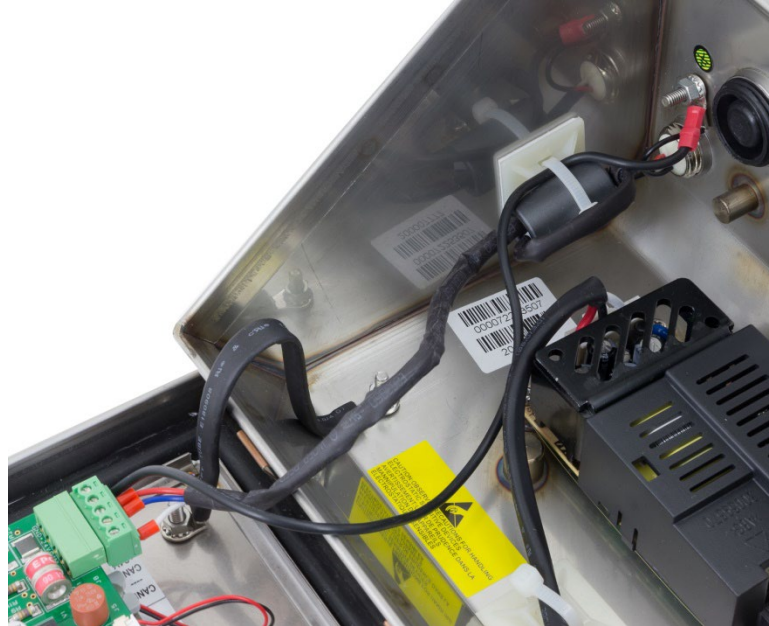
Figure 2-56: Connecteur PowerDeck installé dans l'IND246 POWERCELL
