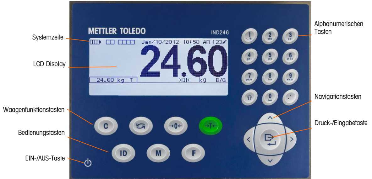
Abbildung 1-5: Layout des IND246-Vorderfeldes
