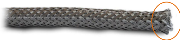
Figura 2-28: Cable POWERCELL cortado
