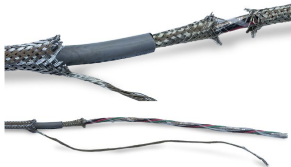
Abbildung 2-36: Inneres Schirmgeflecht abziehen
