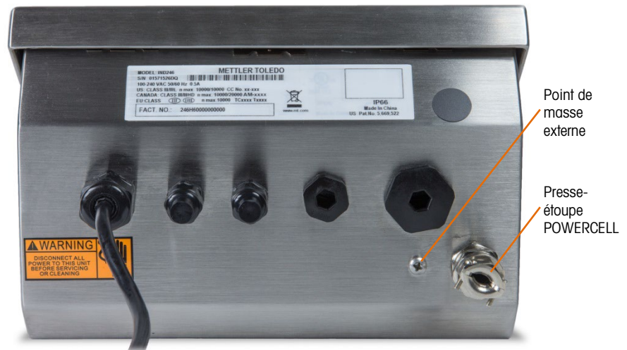
Figure 2-27 : Enceinte IND246 POWERCELL avec presse-étoupe POWERCELL et prise de masse
