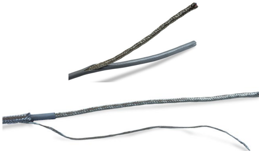
Figura 2-35: spellatura della guaina del cavo dalla schermatura intrecciata interna
