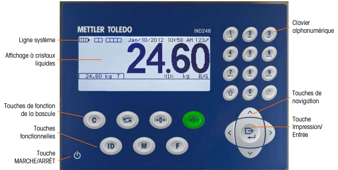
Figure 1-5 : Agencement du panneau avant de l'IND246
