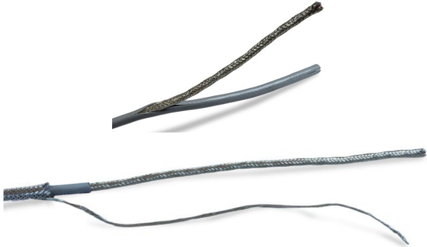
Figura 2-35: Descascando a camisa do cabo da blindagem trançada interna
