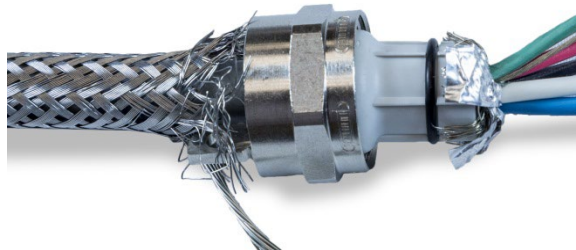
Abbildung 2-43: Die gekürzte und über die Kunststofffülle gelegte Innenabschirmung und Folie
