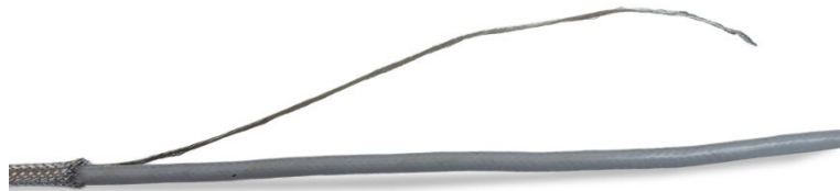
Figura 2-31: Parte posterior aparada da blindagem trançada externa
