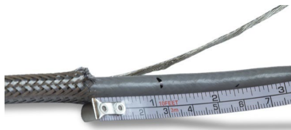
Figura 2-32: segno sulla guaina del cavo
