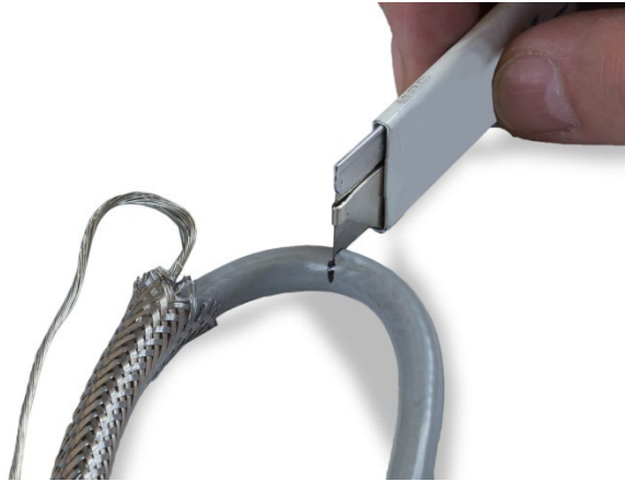
Figura 2-33: taglio della guaina del cavo
