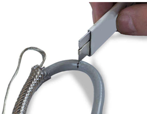
Figura 2-33: Corte em torno da camisa do cabo.
