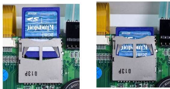
Abbildung 2-70: SD-Karte in den SD-Sockel schieben (links); SD-Karte installiert (rechts)
