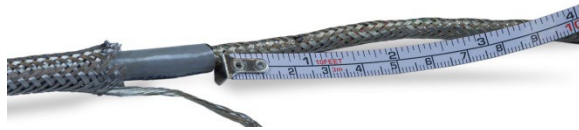
Figura 2-36: Marcando a blindagem trançada interna
