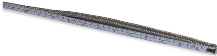
Abbildung 2-28: Äußeres Schirmgeflecht vor dem Schneiden abmessen
