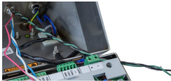
Figura 2-52: fili di messa a terra e di scarico interno ritorti
