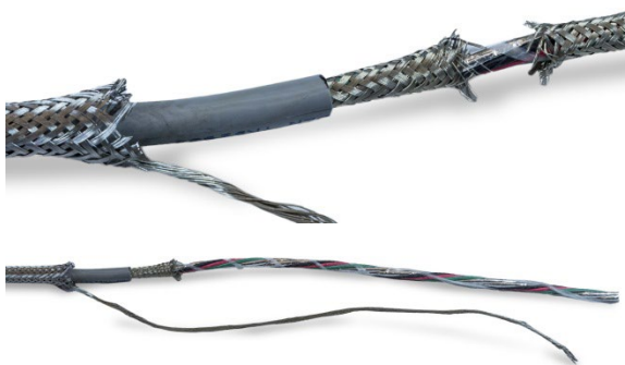
Figura 2-37: rimozione della schermatura intrecciata interna
