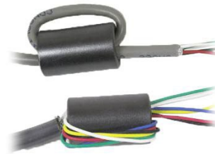
Figura 2-15: Installazione del nucleo in ferrite
