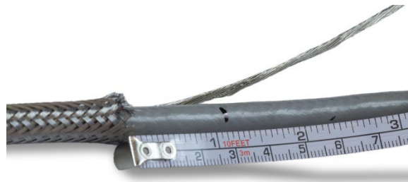
Figure 2-32 : Marquage de la gaine du câble
