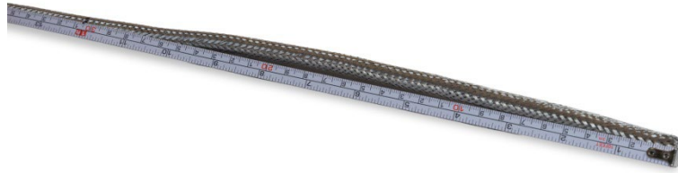
Figura 2-29: Medição de blindagem trançada externa antes do corte
