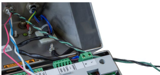
Abbildung 2-51: Erdungsadern mit innerem Beilaufricht verdrillt
