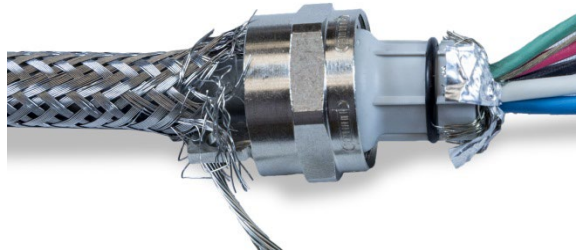
Figure 2-44 : Brins du blindage tressé interne et enveloppe en aluminium découpés à la longueur et repliés sur le passe-câble
