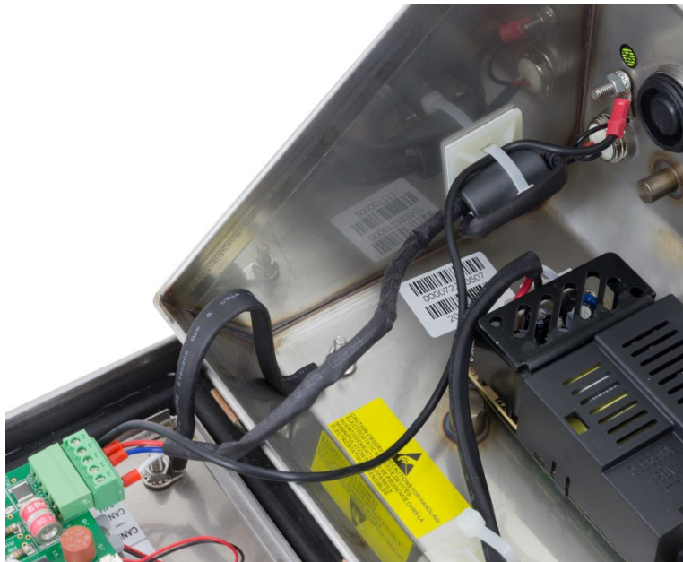
Figura 2-56: Connettore PowerDeck installato nell'IND246 POWERCELL
